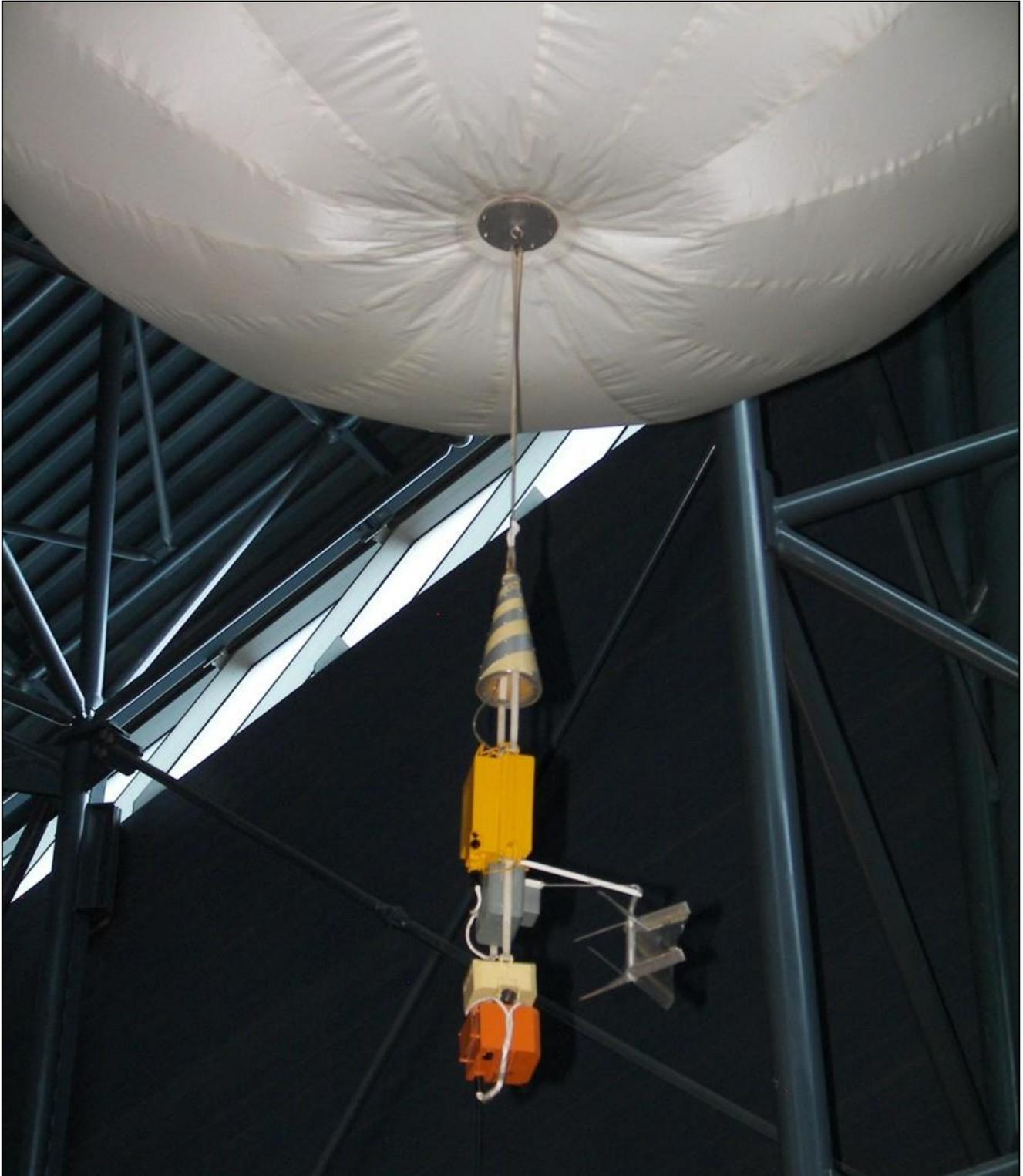
El aterrizador de Vega-1 llegó a Venus con una serie de paracaídas supersónicos y subsónicos para poder reducir la velocidad en su descenso de 10 min. a través de las nubes, el paracaídas principal individual se separó y el módulo de aterrizaje cayó libremente, frenado sólo por el frenado aerodinámico de la capsula.
